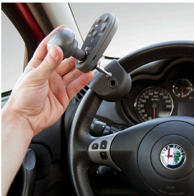
Lorsque l'on n'utilise pas ce dispositif il est facilement démontable et il ne reste que le support sur le volant
